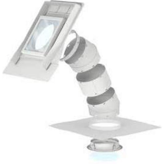
Lleva luz natural dentro de locales sin ventanas o poco iluminados, en los que no es posible instalar ventanas. Está formado por un captador instalado sobre la cubierta que recoge la luz, la transporta al interior de los ambientes situados debajo de él y la distribuye a través de un difusor. Pendiente: De 15° a 60°. Incluye: vidrio superior + tubo de 1,7 m + aro y difusor marco.
